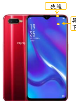
圖三 環境光及近接感測晶片配置於狹縫及屏下位置示意圖
