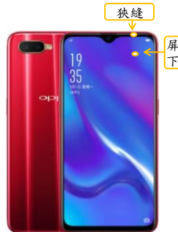
圖六 環境光及近接感測晶片配置於狹縫及屏下位置示意圖
