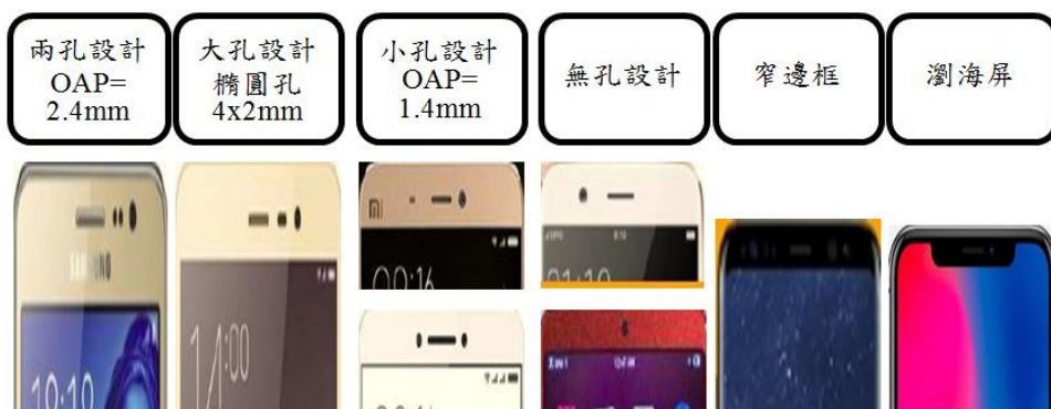
圖四 開孔之環境光感測晶片及近接感測晶片設計
