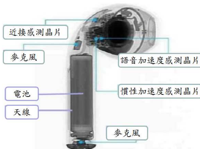
圖十二 TWS 藍芽耳機感測晶片拆解
