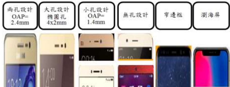
圖七 開孔之環境光感測晶片及近接感測晶片設計
