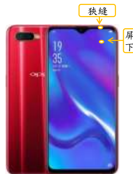
圖八 環境光及近接感測晶片配置於狹縫及屏下位置示意圖
