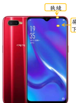
圖六 環境光及近接感測晶片配置於狹縫及屏下位置示意圖
